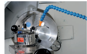
Hochgenaue Spindellagerung mit 3 vorgespannten Schrägkugellagern für hohe Traglast mit zusätzlicher Riemenzugentlastung
