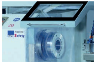
Spindelkasten mit Vorgelege-Schaltung für hohe Drehmomente (nur bei LZ 400VS2)
