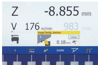
Intuitives Kegeldrehen mit Schlichtaufmaß und automatischer Vorschubabschaltung
